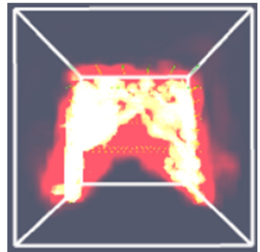
(d) Simulated flame shape at 447 s
